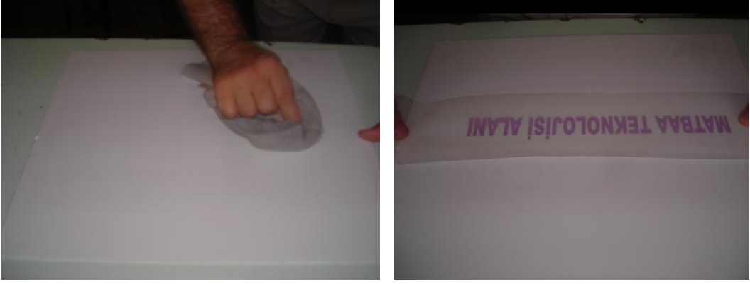
Resim 2.8: Transfer folyosunun uygulama yüzeyine yerleştirilmesi
