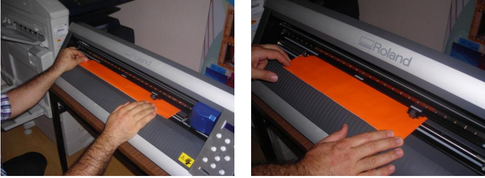
Resim 1.4: Malzemenin makineye yüklenip tutucu tekerlerin yerlerinin ayarlanması
