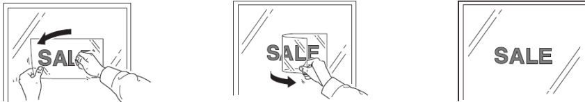
Şekil 2.6: Dıştan transfer işleminin gerçekleştirilmesi
