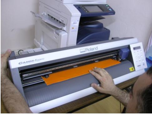
Resim 2.3: Folyo kesim makinesinin kesime hazır hale getirilmesi
