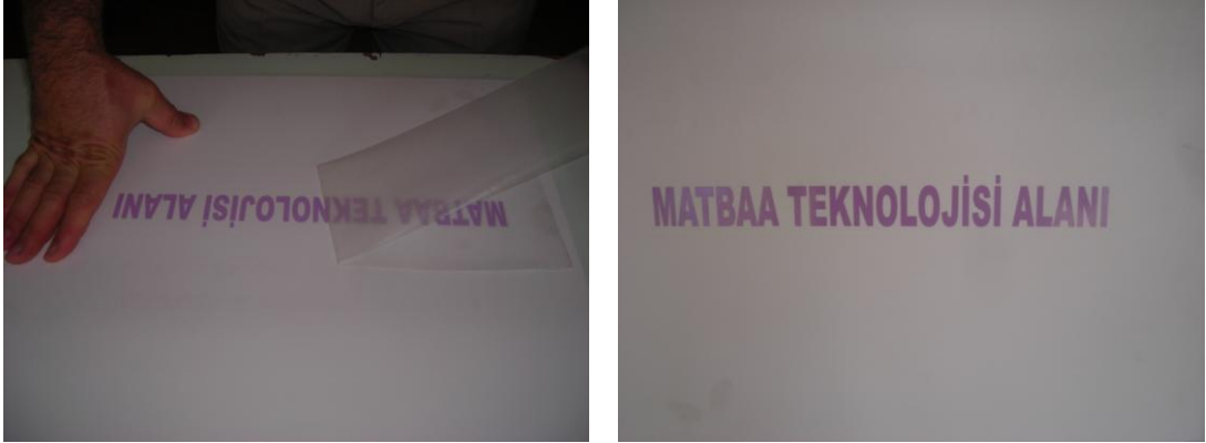
Resim 2.9: Transfer folyosundaki işin uygulama yüzeyine yapıştırılması
