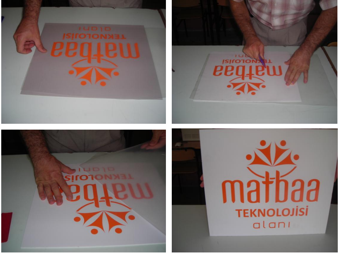
Resim 2.12: Uygulanacak yüzeye dıştan transferin gerçekleştirilmesi
