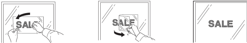
Şekil 2.5: Kesilen işin transfer folyosu vasıtası ile uygulama yüzeyine yapıştırılması
