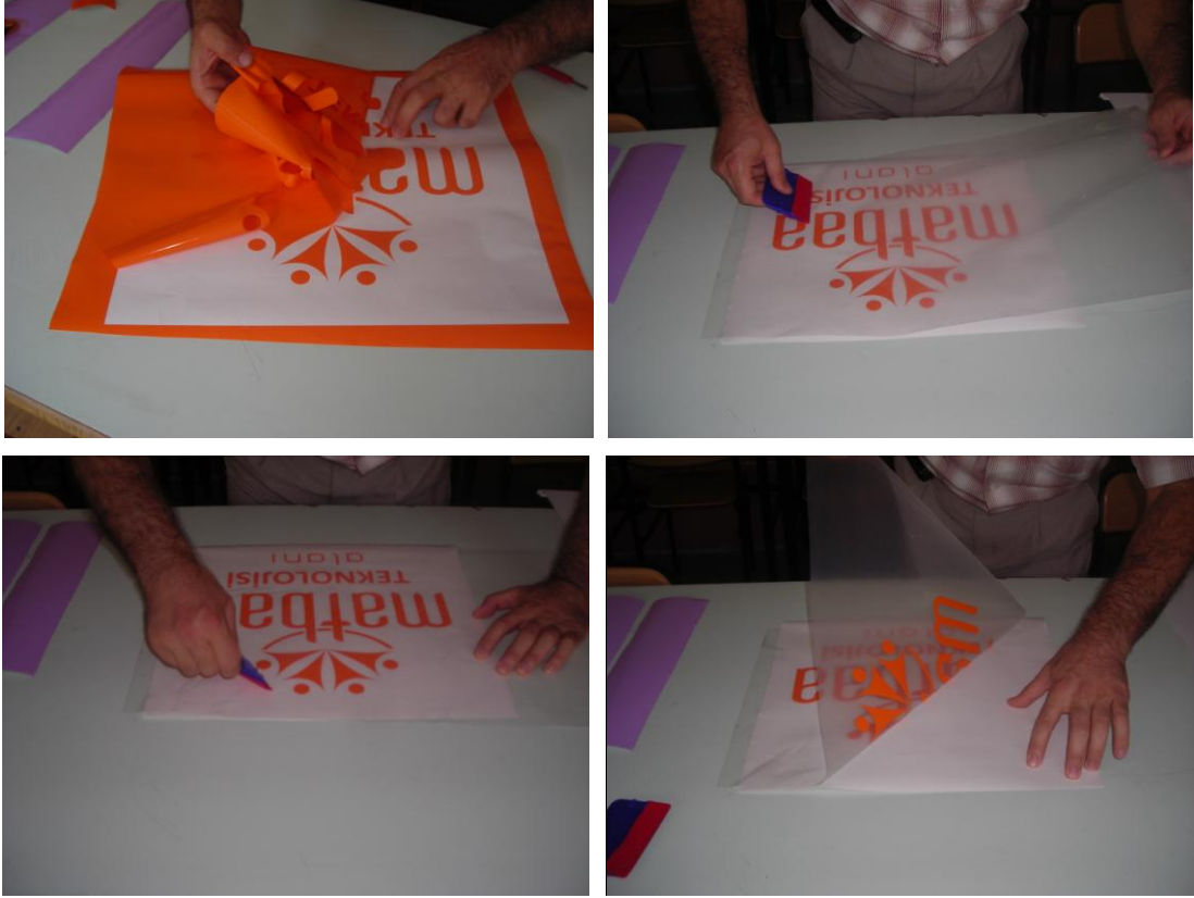
Resim 2.7: Kesimi yapılan işin transfer folyosuna aktarılması
