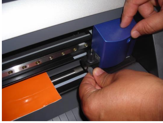
Resim 1.3: Bıçak tutucunun makineden sökülmesi
