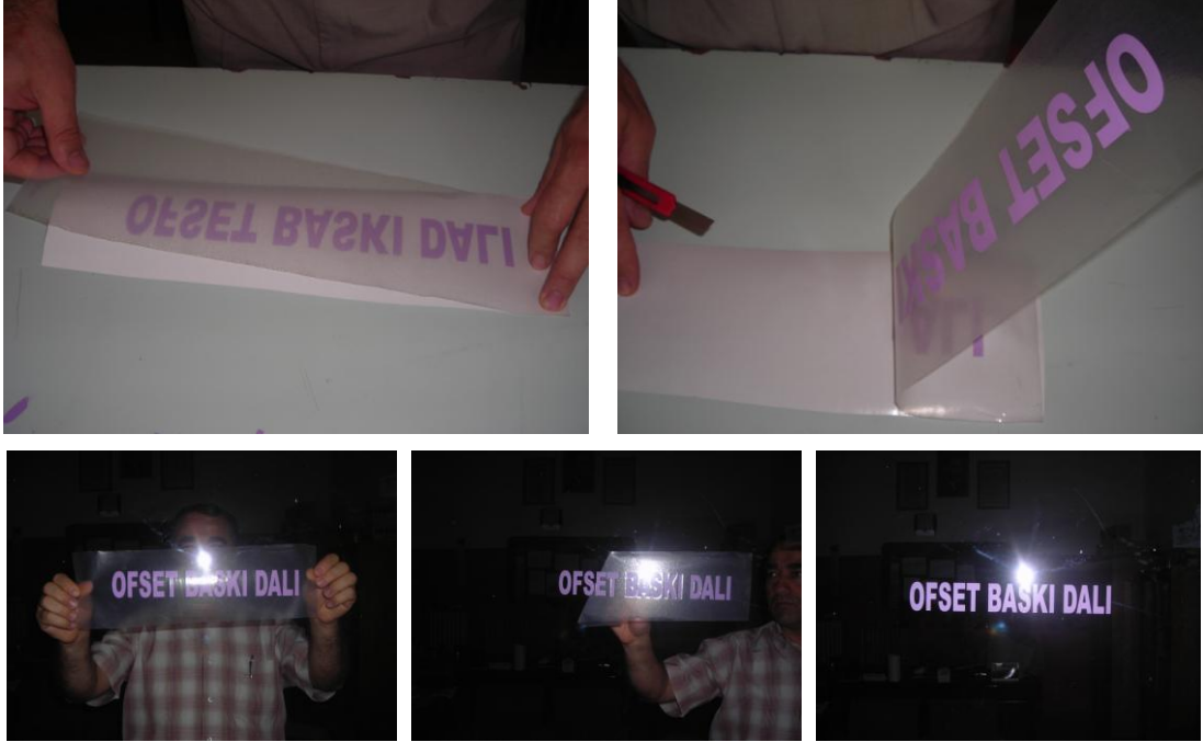
Resim 2.11: Uygulanacak yüzeye içten transferin gerçekleştirilmesi
