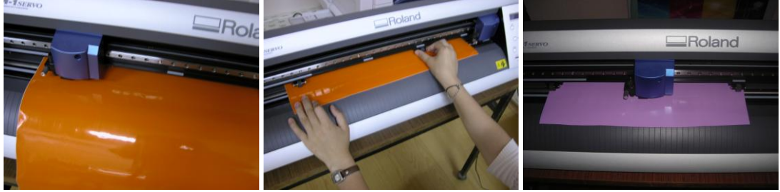
Resim 2.5: Folyo kesim makinesinin kesime hazır hale getirilip kesim yapma aşaması
