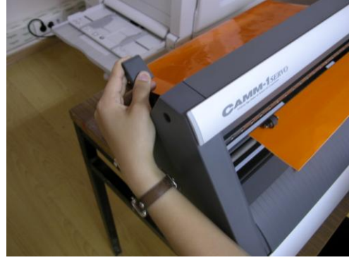
Resim 2.3: Folyo kesim makinesinin kesime hazır hale getirilmesi
